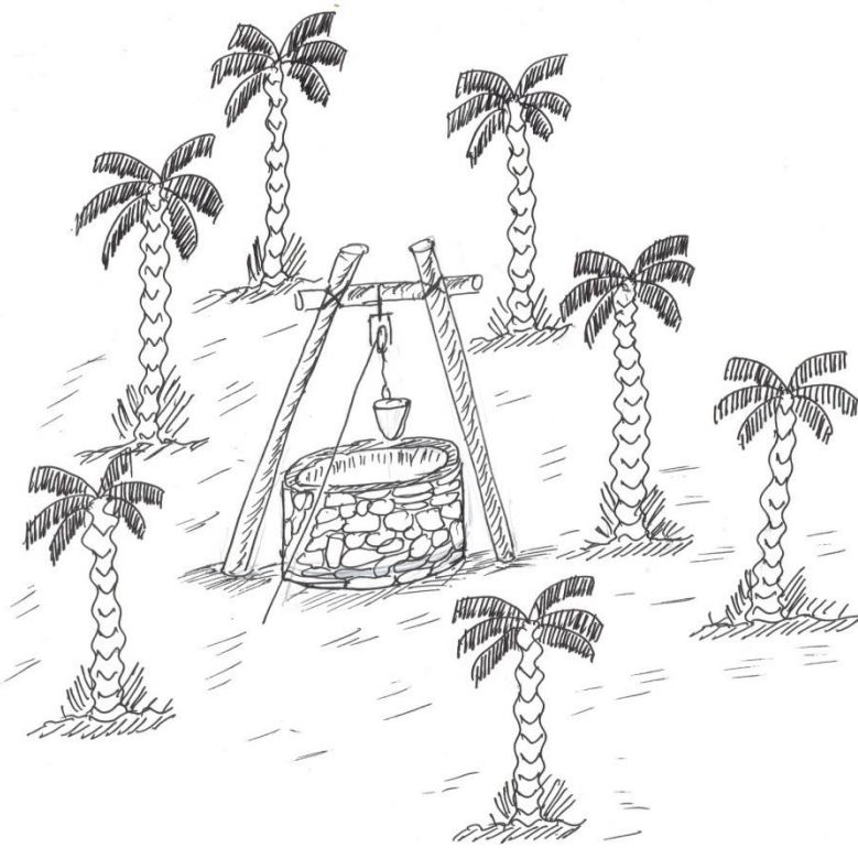
Fig. III.3. Schéma d'un puits à poulie (Remini, 2016)
