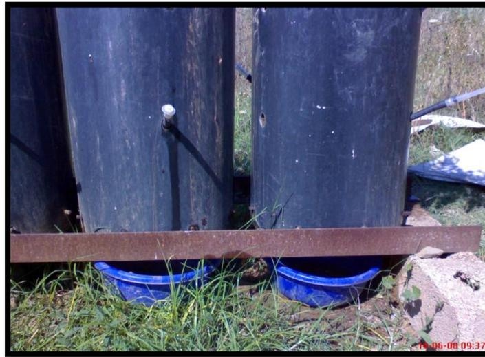
**Figure IV.3 :** Les bassines recueillant les eaux de drainage.
