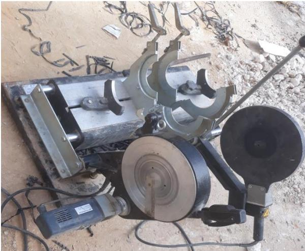
Figure VII. 6: Machine de soudage bout à bout.
