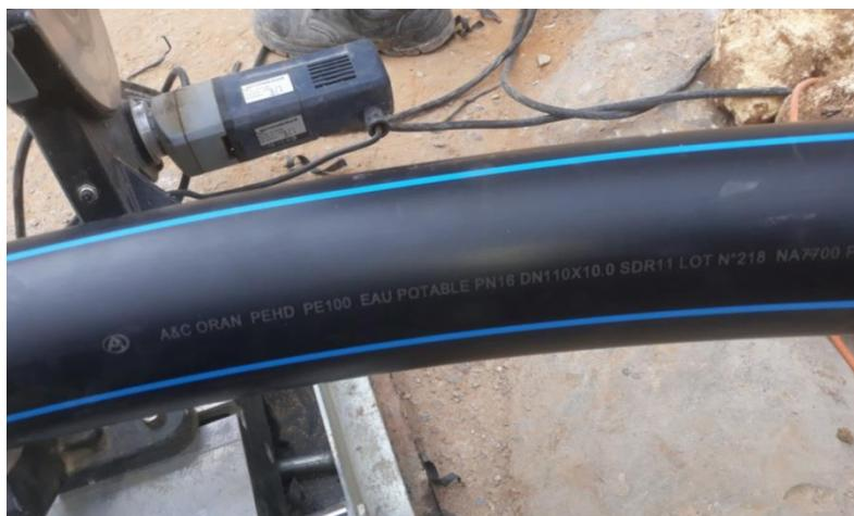
Figure VII. 3: Tubes en polyéthylène haute densité.
