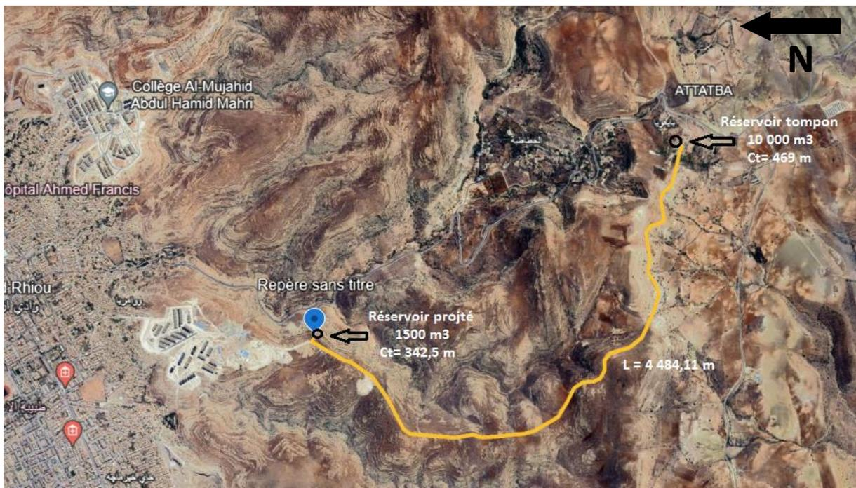
**Figure III. 1:** Schéma du tracé de la conduite d'adduction gravitaire .
