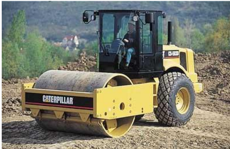
Figure VII. 7: Compacteur sur terrain
