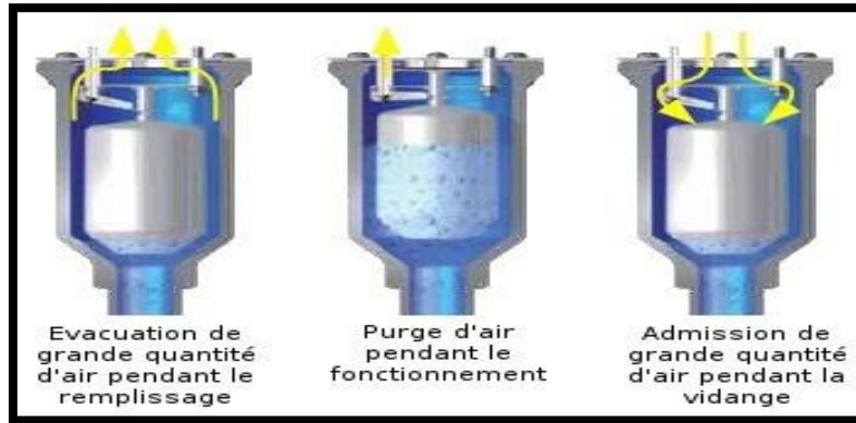
Figure VI. 5: Fonctionnement d'une ventouse
