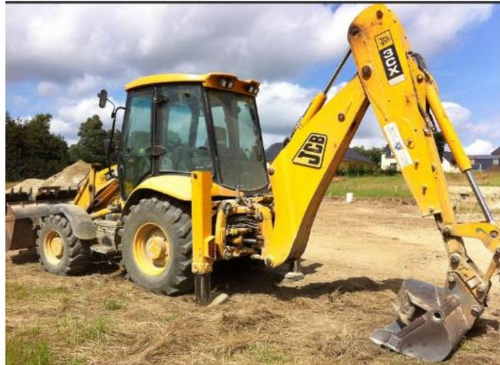
Figure VIII.3: Pelle équipée en rétro
