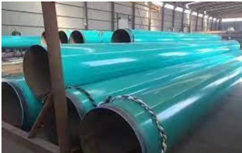
Figure □I.17 : Protection contre la corrosion extérieure avec revêtement en polyéthylène.
