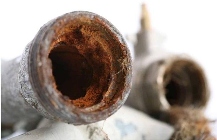
Figure □I.15 : corrosion interne dans une conduite.
