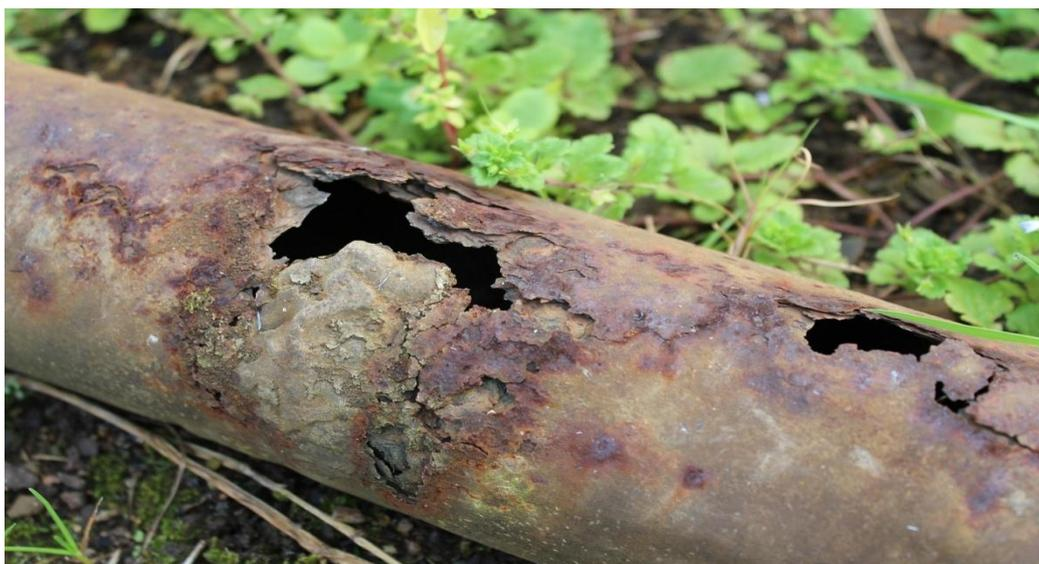
Figure □I.16 : Corrosion externe dans une conduite.
