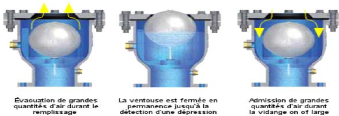
Figure V.19: Fonctionnement la ventouse.
