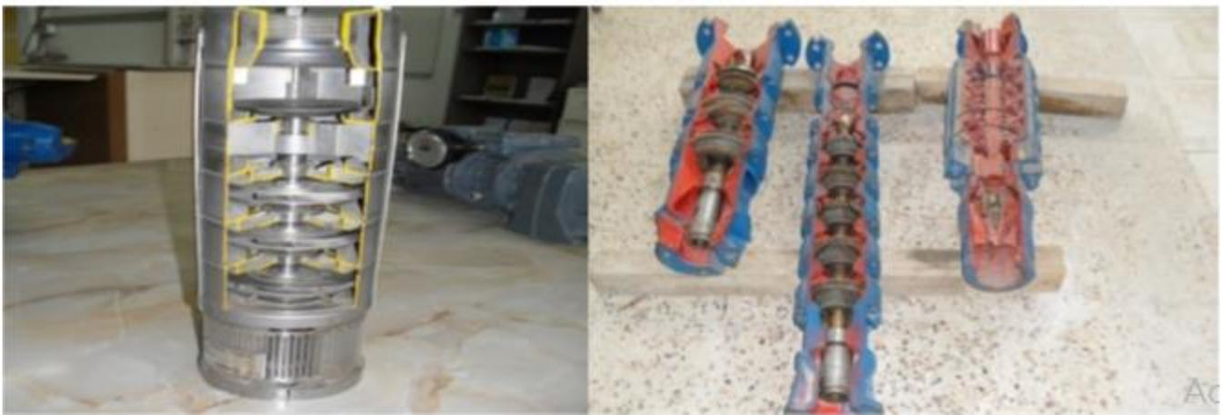
Figure V.2': Pompe multicellulaire immergée à axe vertical
