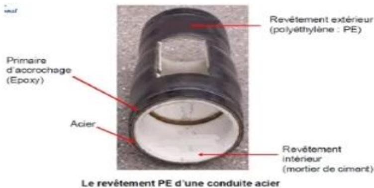
**Figure VII.20:** Le revêtement PE d'une conduite en acier (site SCRIBD)
