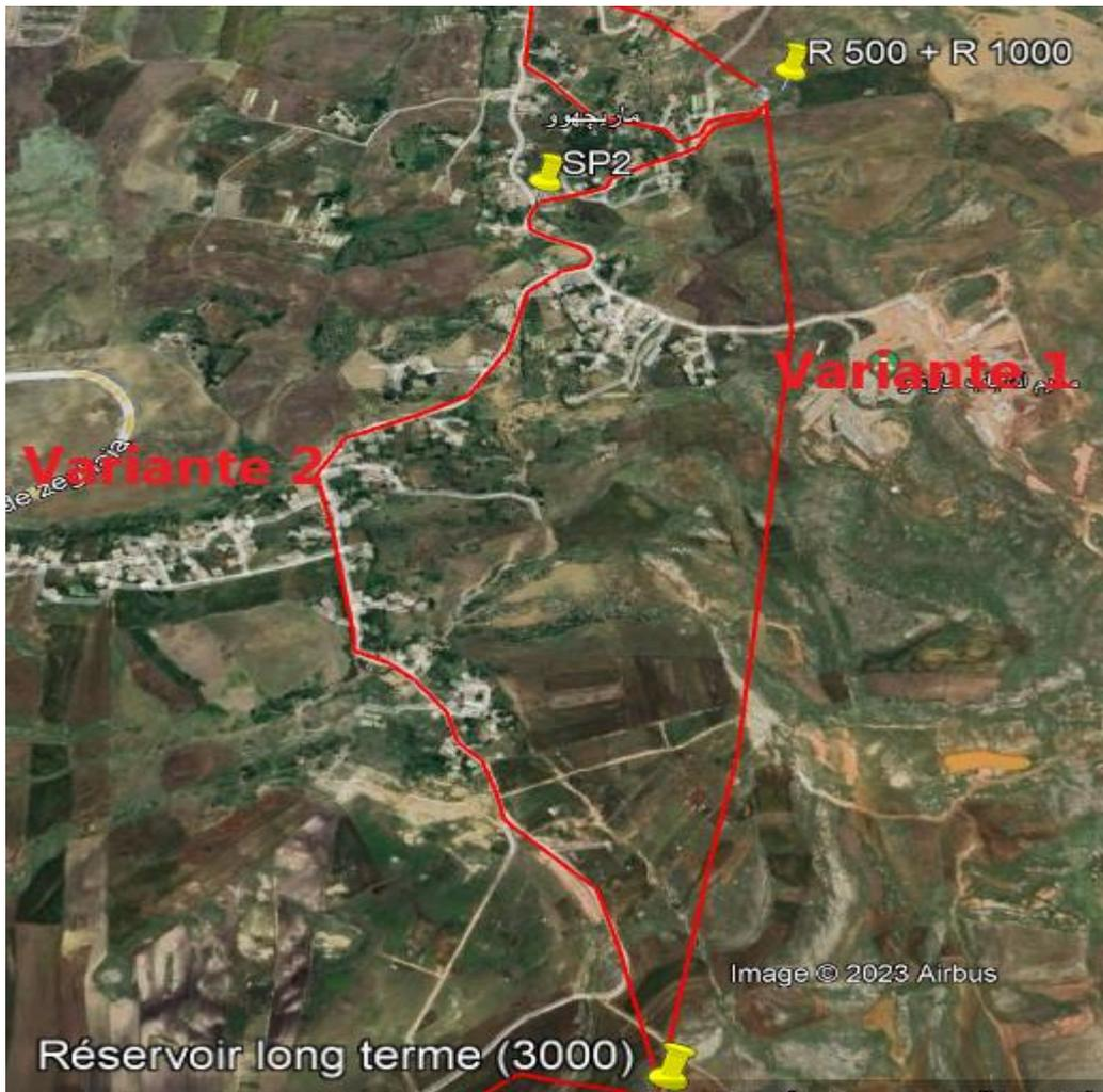
Figure IV.3: Adduction de la deuxième station de pompage vers réservoir de stockage R2
