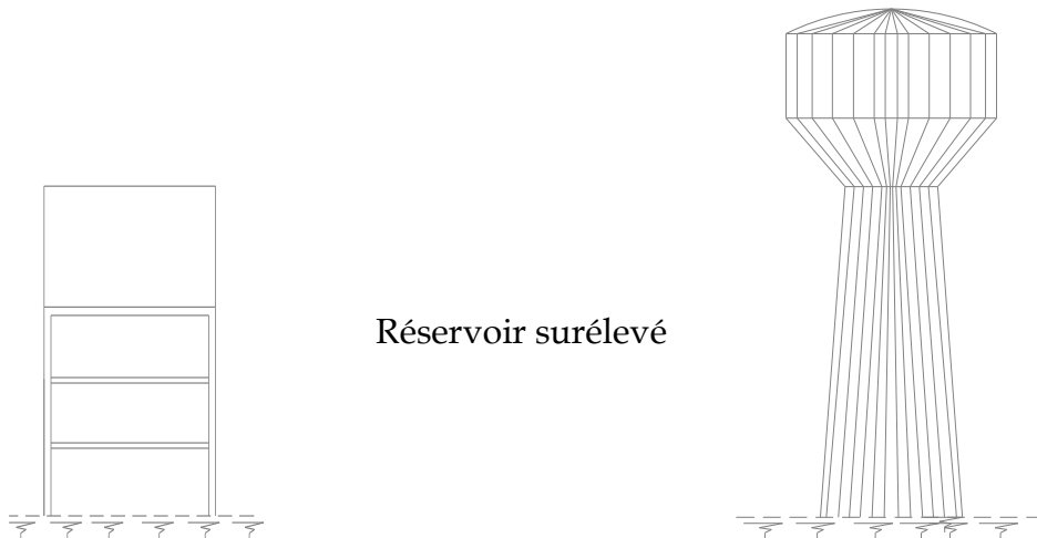
Figure V. 3 : Positions du réservoir par rapport au sol (2).
