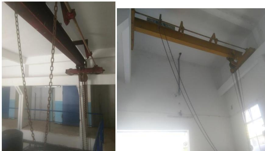
Figure III. 4 : Pont roulant de la SP1 et la SP3
