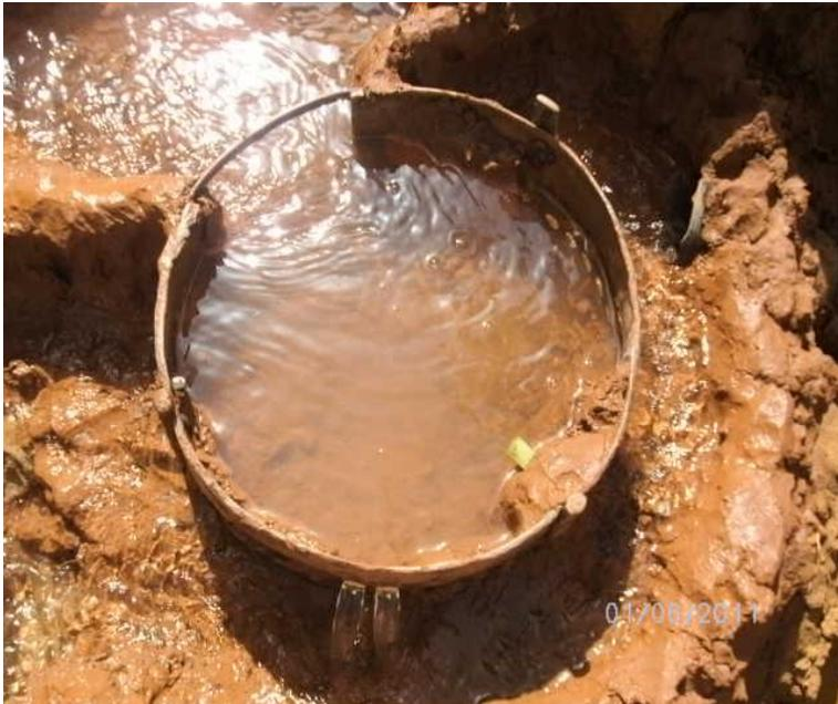
**Fig. 4.8. Utilisation de la Chegfa lors d'une opération de mesure d'un faible débit (photo Salah Hebi)**
