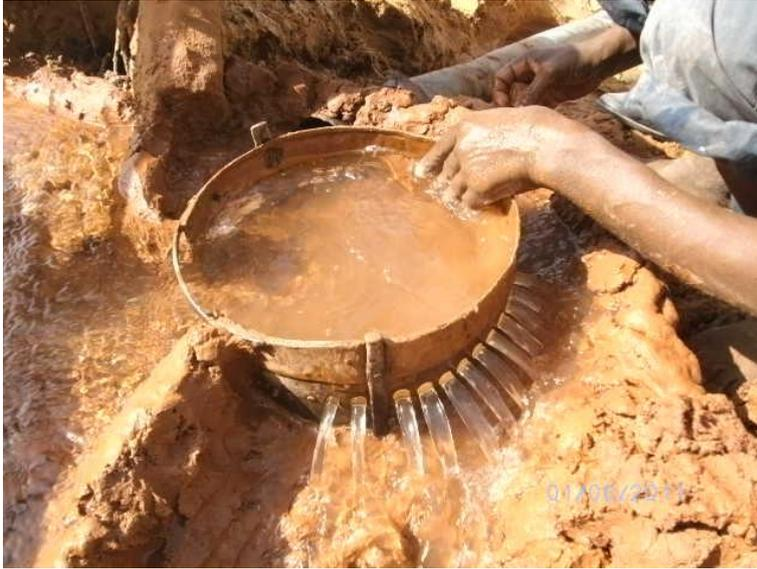
**Fig.4.7. Utilisation de la Chegfa lors d'une opération de mesure d'un fort débit (photo Salah Hebi)**
