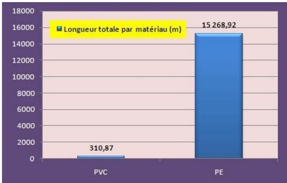
**Figure I.5 :** Longueur des conduites de distribution en fonction du matériau.
