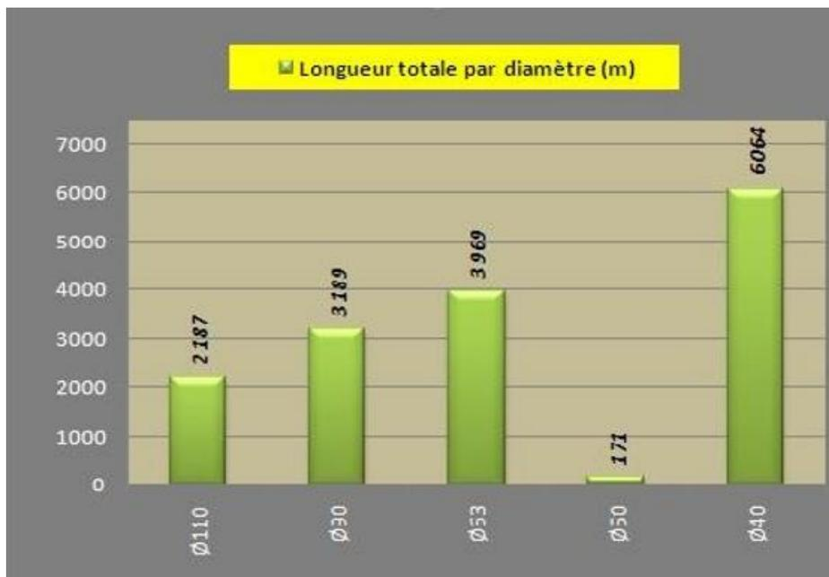
**Figure I.4 :** Longueur des conduites de distribution en fonction du diamètre
