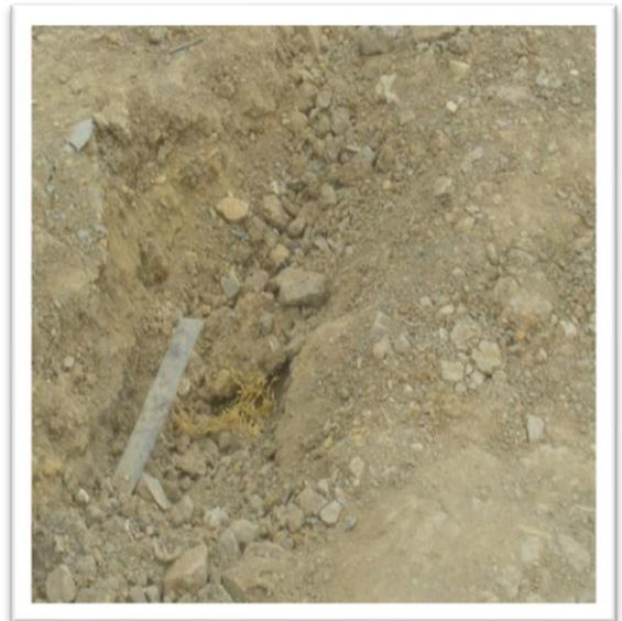
**Fig III.5. Conduite en AG 50mm cassée
