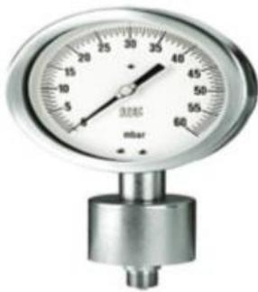
Figure VI.12 : Manomètre à soufflet
