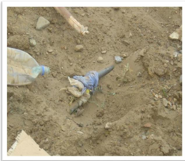
**Fig III.4. Conduite en PEHD 50mm cassée
