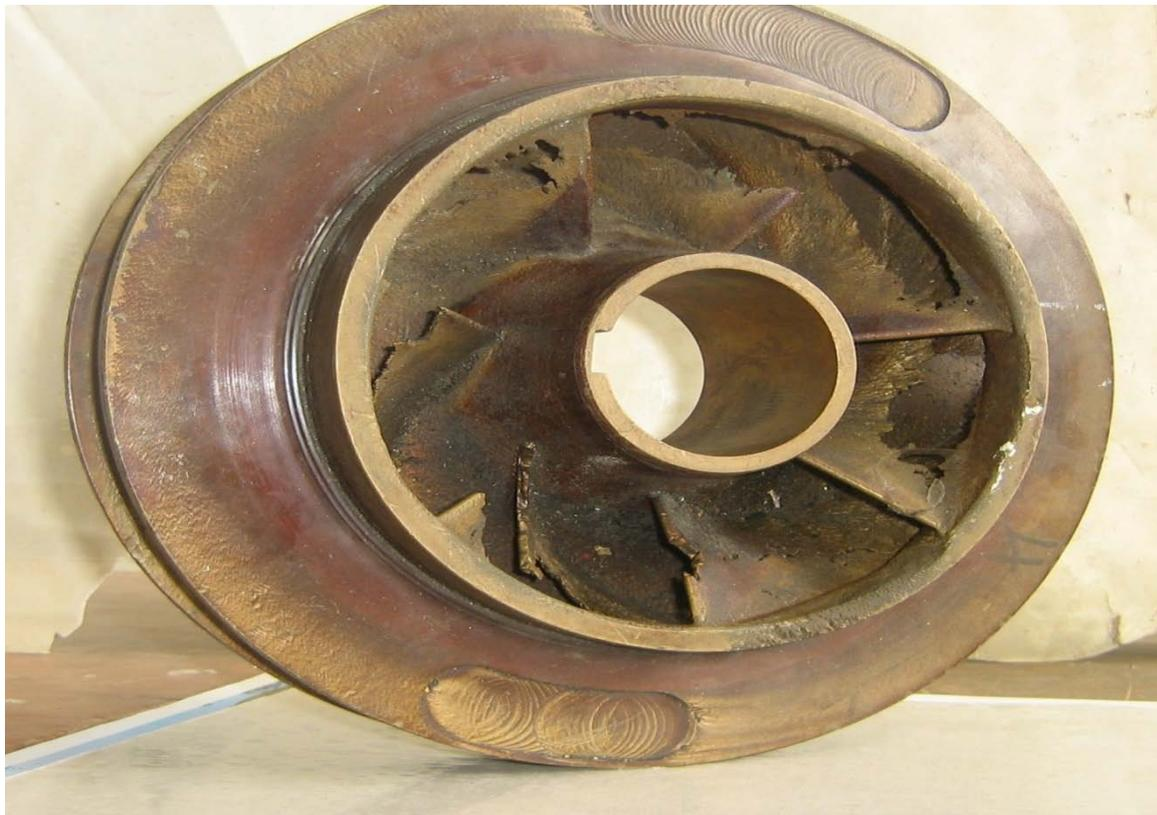
**Figure IV.19** : L'érosion par cavitation de la roue.
