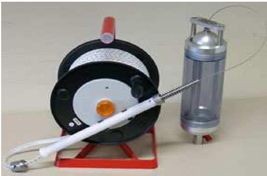
Figure N°IV-02 La bouteille de Dr Blasy (préleveur)
