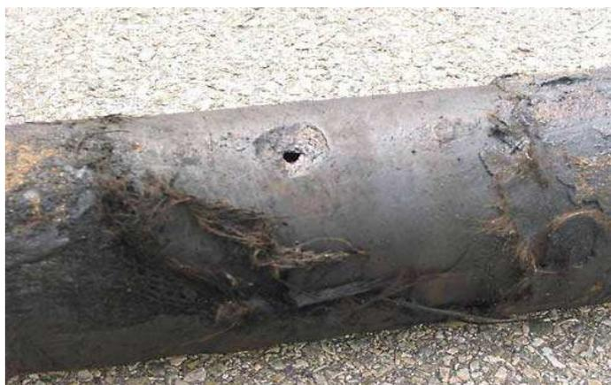
Figure n° VIII -1 : Effet de la corrosion sur une conduite en acier
