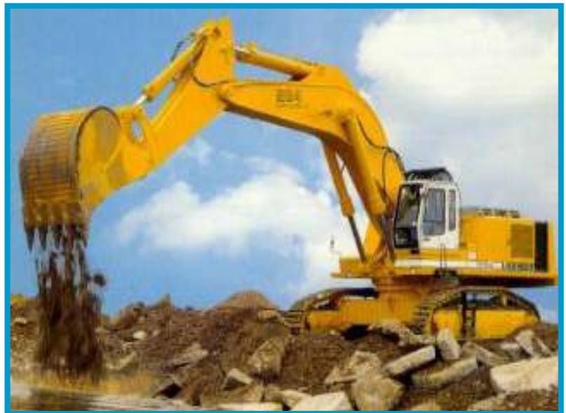
**Fig. VII-1 : Pelle équipée en rétro**
