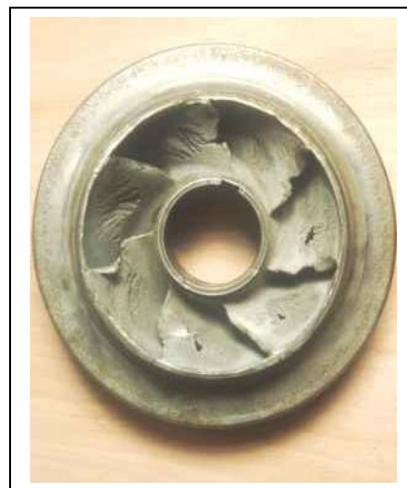
**Cavitation sur les aubes d'une pompe centrifuge [12].**
