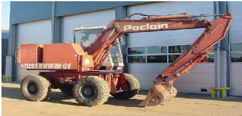
Figure VII.4: Pelle équipée en rétro
