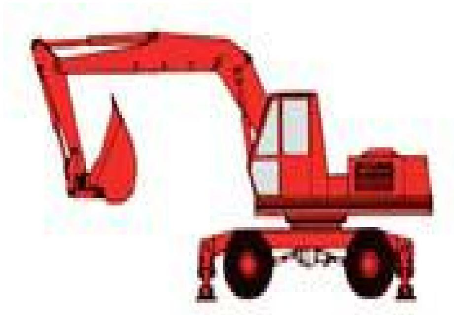
**Fig VII-4-schéma de pelle hydraulique à pneu équipée à retro**
