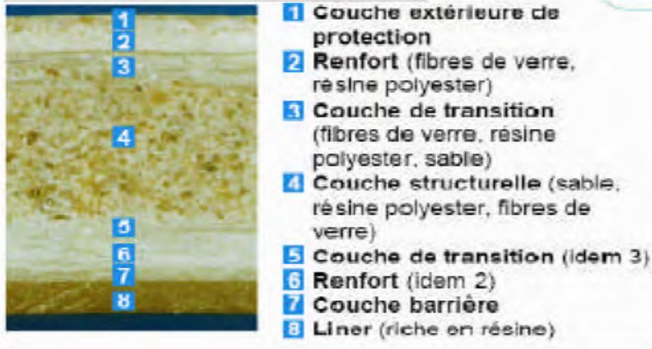
Figure N° 01 : Constitution de la paroi du tuyau PRV.
