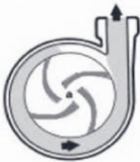
Le rôle d'une pompe consiste en effet à conférer de l'énergie au liquide pompé (énergie transformée ensuite en débit et en hauteur d'élévation) selon les caractéristiques de fabrication de la pompe elle-même et en fonction des besoins spécifiques à l'installation. Le fonctionnement est simple : ces pompes utilisent l'effet centrifuge pour déplacer le liquide et augmenter sa pression.
