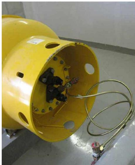
figure VII-10. Vue d'un fût connecté en soutirage liquide
