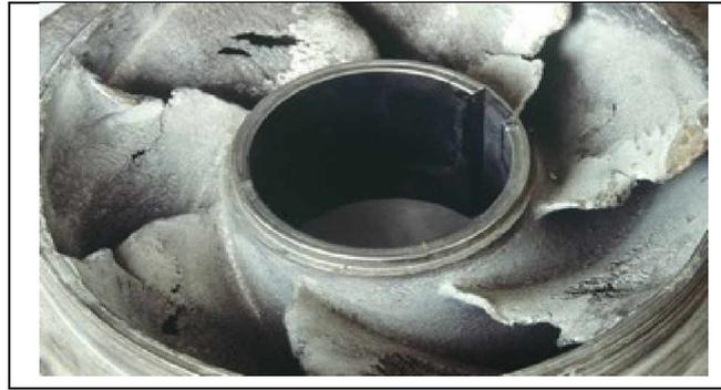
figure V-10. Roue soumise à la cavitation
