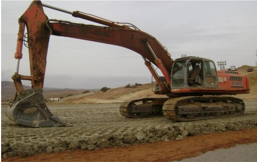
Figure VII-2 : pelle hydraulique équipée en retro
