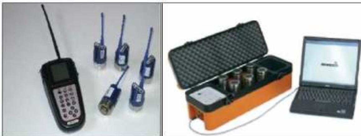
**Fig. IX.2:** Appareils enregistreurs de bruits
