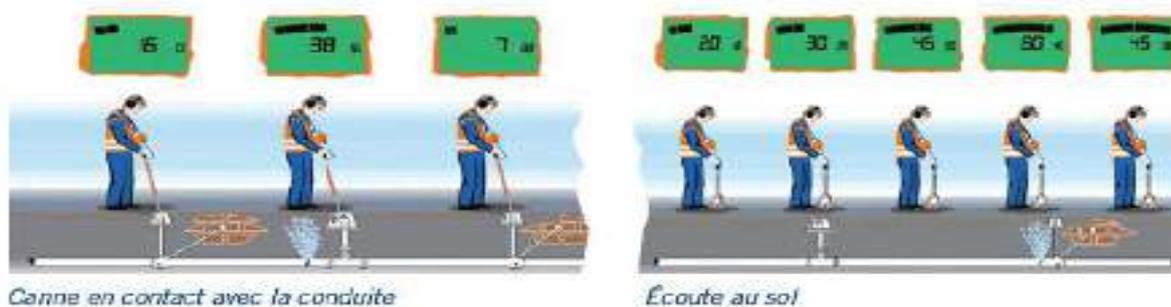
**Fig.IX.4:** Les appareils à amplification électronique
