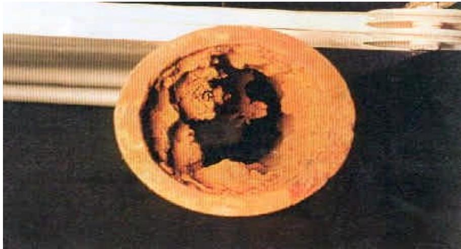
Figure VI-2: Corrosion interne dans une conduite.
