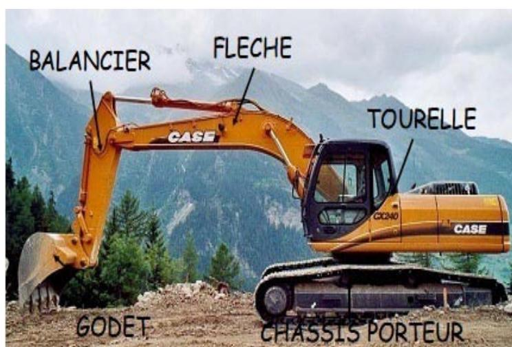
Figure VII.6 : Pelle hydraulique
