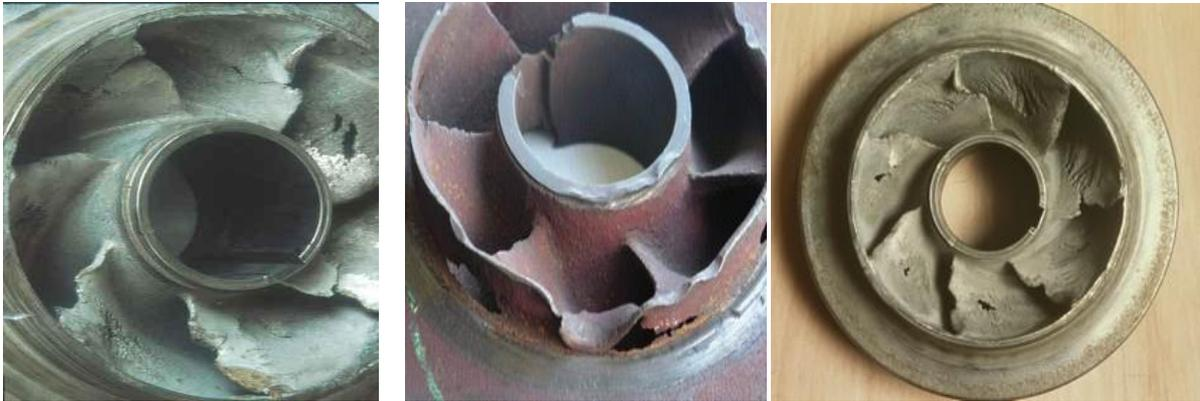
Figure V.7 : Roues soumises à la cavitation.
