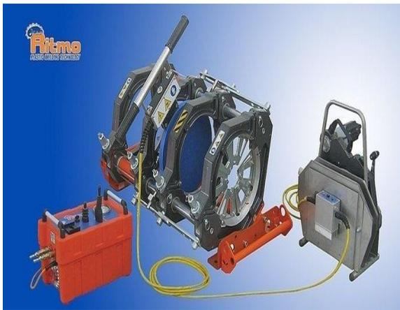
Figure IV.1 : Accessoires de raccordement bout à bout.
