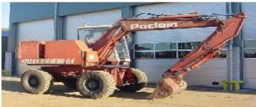
**Figure IX.4-** Pelle équipée en rétro
