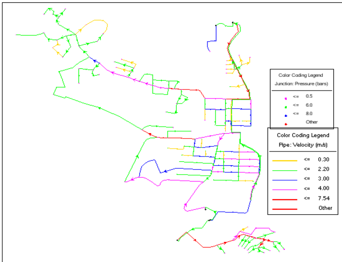
Fig IV.1 : Carte des vitesses et pressions – cas de pointe -
