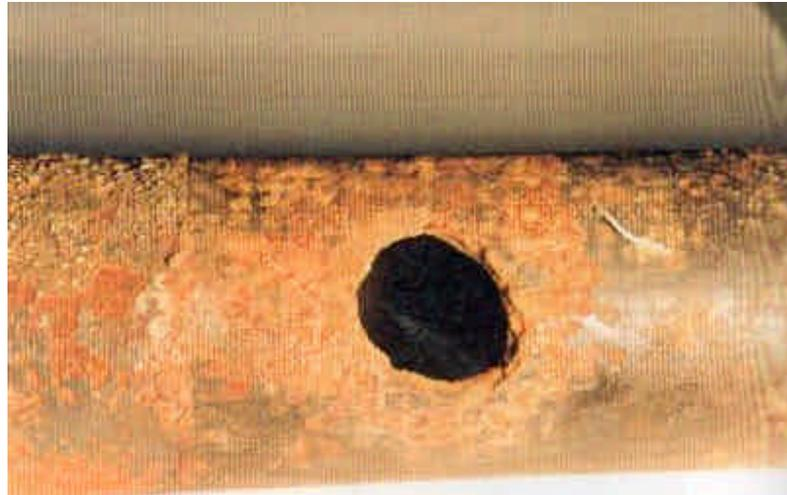
*Figure VI-5 : Corrosion externe dans une conduite*
