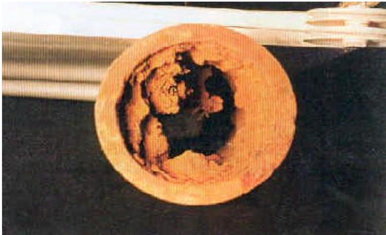
*Figure VI-4 : Corrosion interne dans une conduite*
