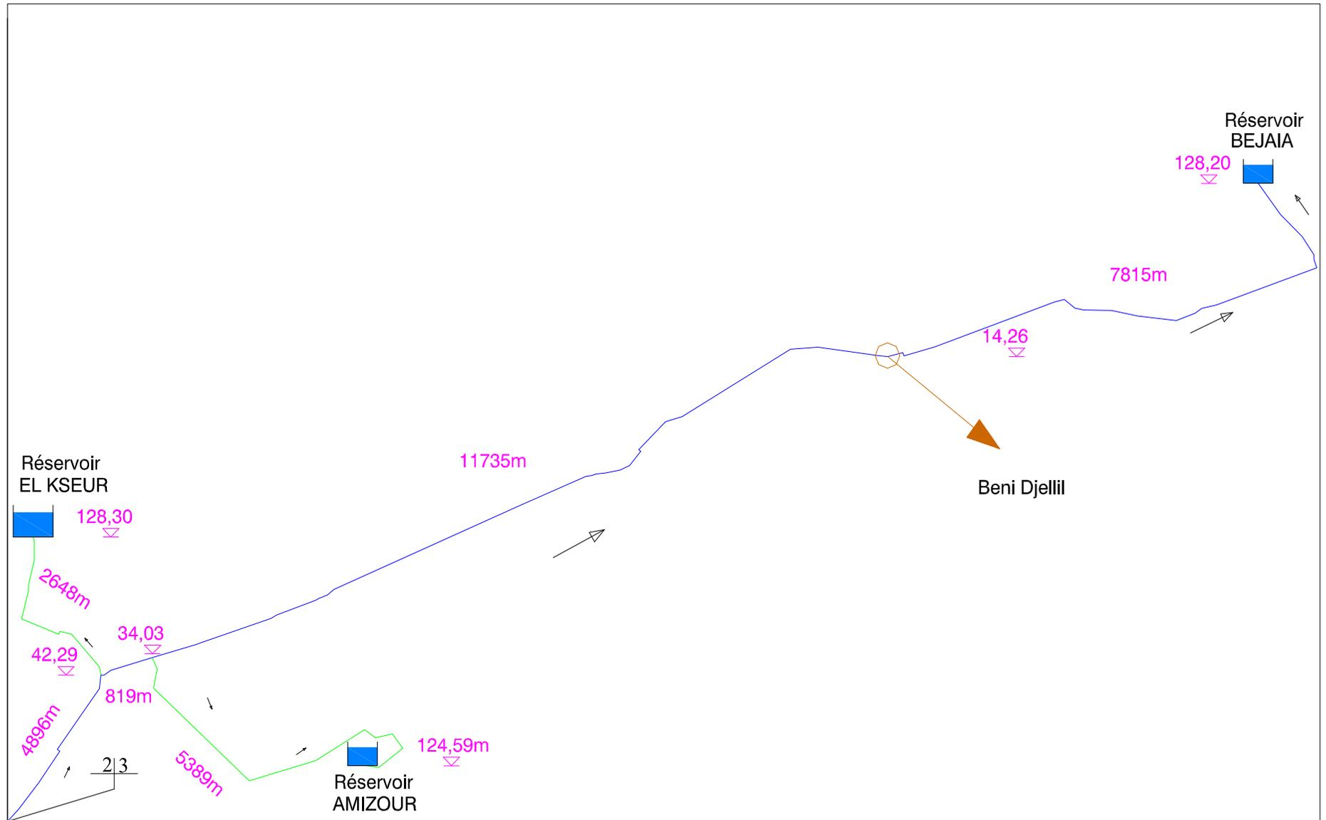
Figure IV.2.d : Tracé de la variante N°01, tronçon N° 03 (Partie avale).
