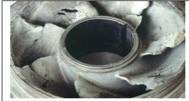
**Figure V-08 :** Roue soumise à la cavitation.
