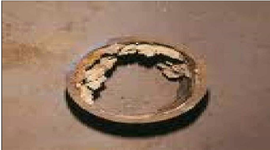
***Figure VI-07: Corrosion interne dans une conduite.99***
