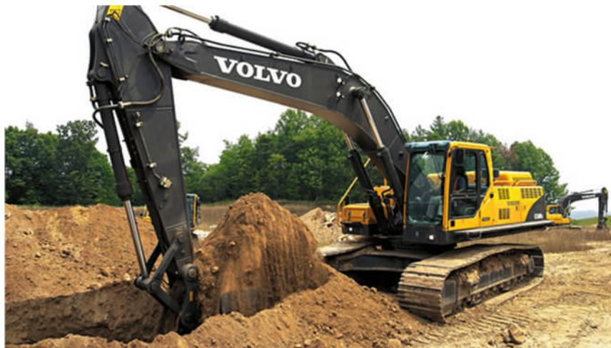
**Figure VIII.2 : Pelle hydraulique**
