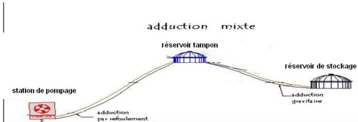
**Figure III.3:** schéma d'une adduction mixte
