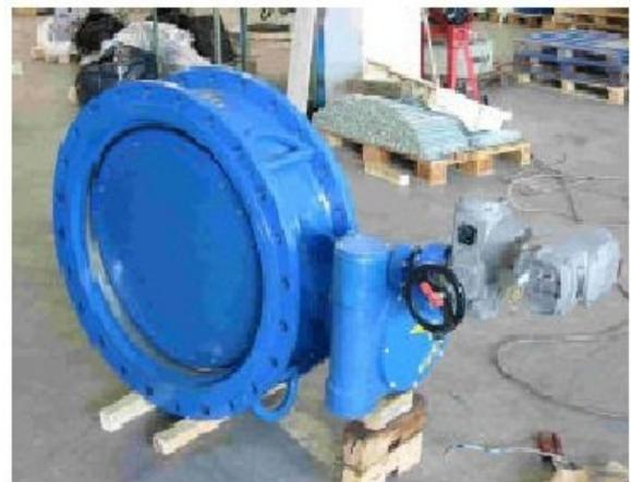
vanne à papillon avec actionneur électrique
