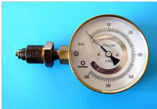
**Figure V.16** : manomètre de (0-600) bar.
