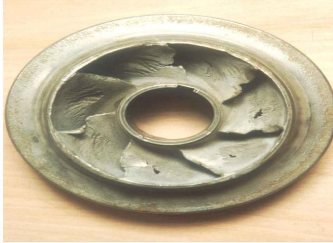
Figure IV-16. Roue soumise à la cavitation.
