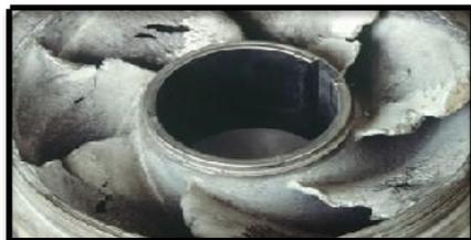
**Figure IV-20 : Roue soumise la cavitation**
