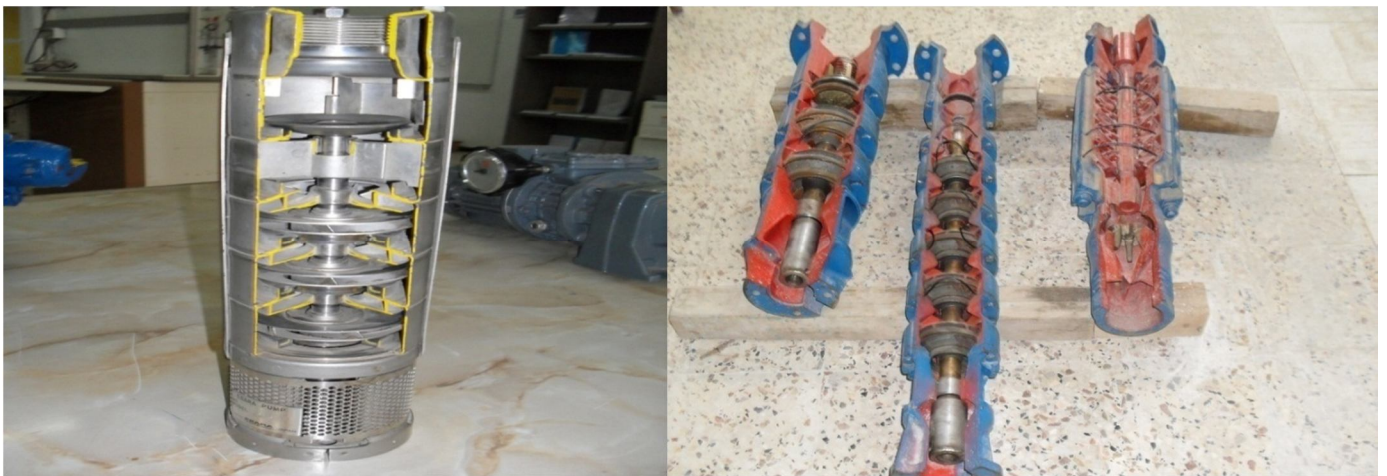
Figure V.12 : Pompe multicellulaire immergée à axe vertical
