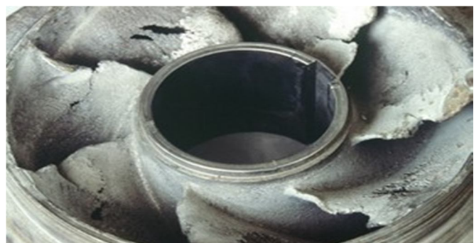
Figure V.24 : Roue soumise à la cavitation
