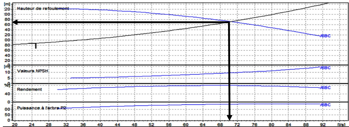
Figure V.18 : Point de fonctionnement de la pompe
