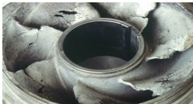
Figure IV.10: Roue soumise à la cavitation
