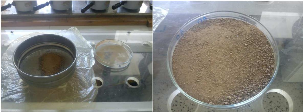
Fig. 90 : Préparation des échantillons : après homogénéisation, les échantillons sont passés au travers d'un tamis de largeur de pores 2 mm.
