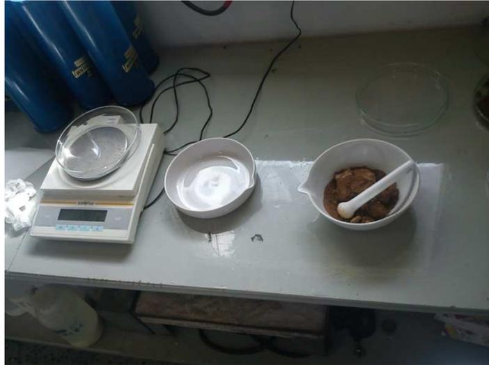
Fig. 89 : Broyage et pesages des échantillons du sol prélevés.
