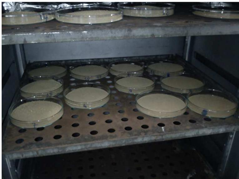
Fig. 91 : Séchage des échantillons à 100°C durant 24 h.
