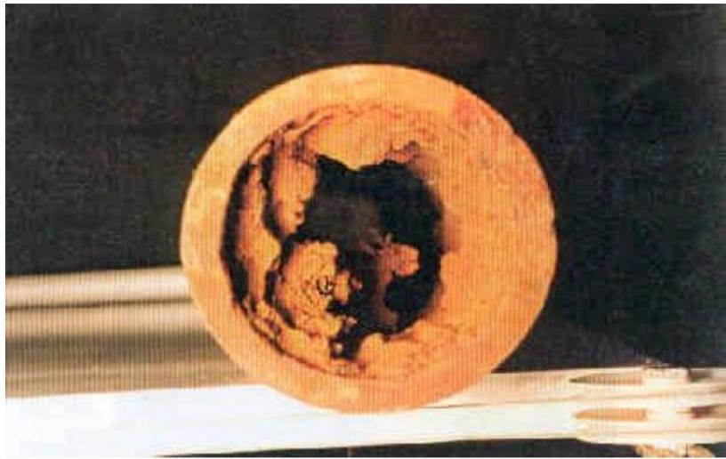
**Figure V.1:** conduite de diamètre 80 mm ayant subi des dépôts ferriques de corrosion interne.
