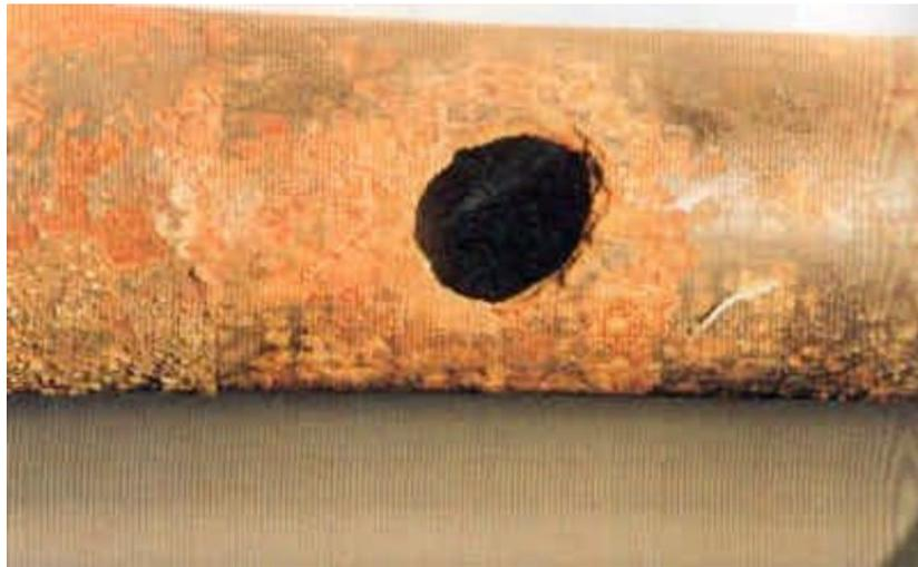
**Figure V.2:** conduite de diamètre 80 mm ayant subi une corrosion externe localisée.
