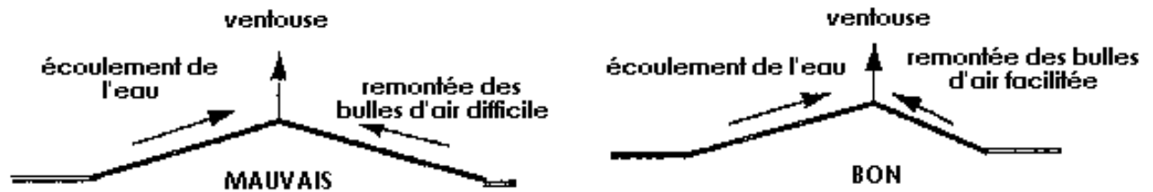
Figure III-1.1 : l'emplacement des ventouses
