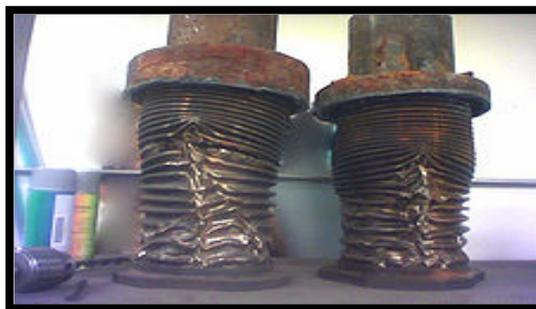
**Figure VI-1 :** *Joint de dilatation détruit par un coup de bélier*
