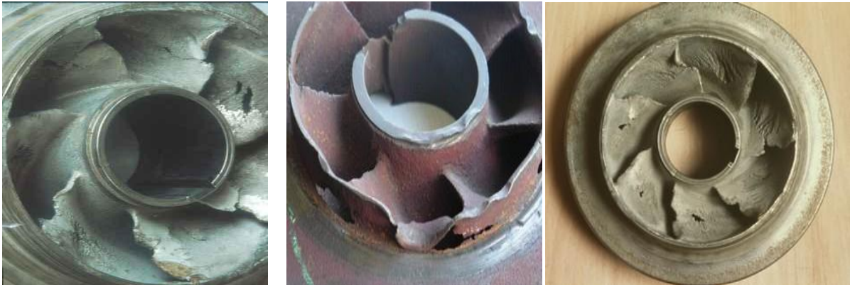
Figure VI.5 : Roues soumises à la cavitation.
