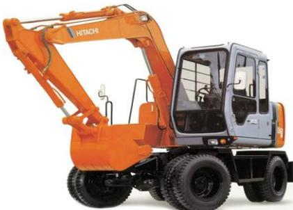
Figure N° VIII.2: La pelle hydraulique
