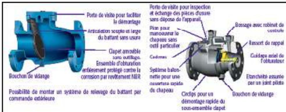
**Figure VI.9** Clapet à simple battant (à brides) (D'après document Danfoss Socla)
