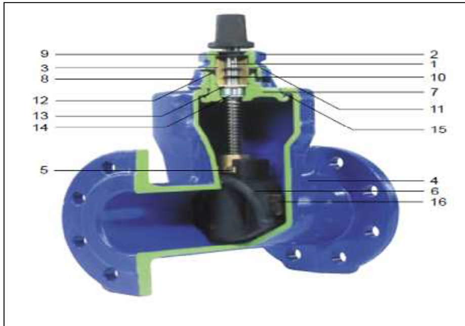
Figure VII.12 : Robinet vanne à opercule
