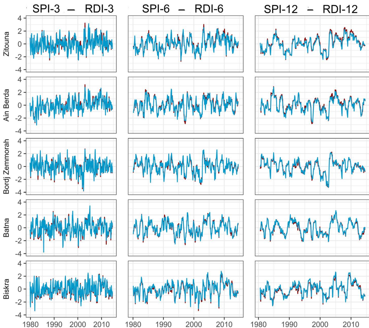
Fig. 4.20. Variabilité temporelle de l'indice SPI (—) et RDI (—) pour trois échelles de temps (3, 6 et 12 mois) à Zitouna avec un climat humide, Ain Berda Subhumide doux, Bordj Zemmorah, Subhumide sec, Batna semi-aride, et Biskra aride, pour la période de 1979-80 à 2013-14 (Merabti, et al 2017a)
