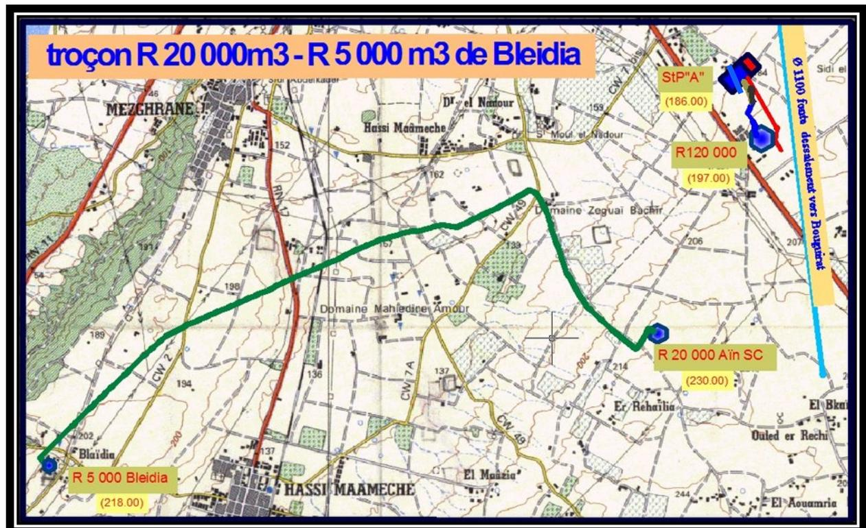
**Figure III.6 :** Plan de situation du tracé de la conduite reliant le réservoir 20 000 m<sup>3</sup> d'Ain Sidi Chérif et le réservoir 5 000 m<sup>3</sup> de Bleidia.
