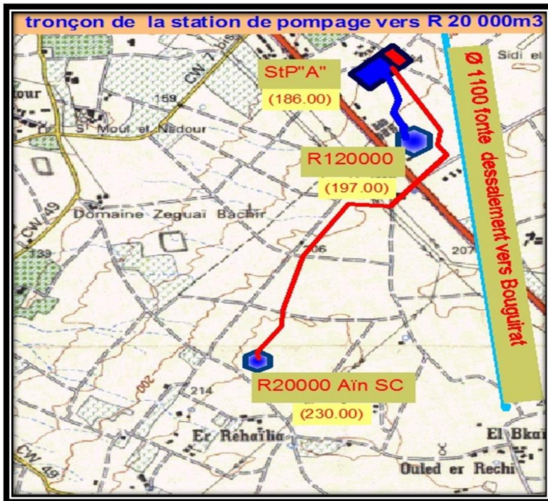
Figure III.7 : Plan de situation de la conduite de refoulement reliant la station de pompage « A » et le réservoir 20 000 m<sup>3</sup>.
