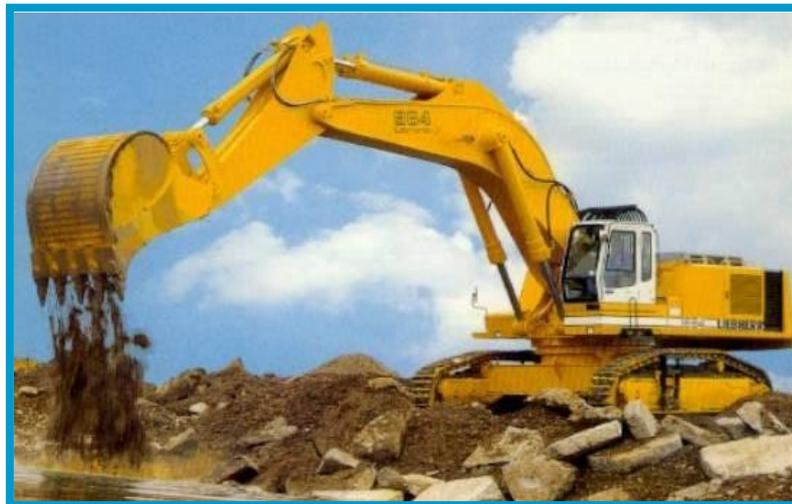
Figure VI.2. Pelle équipée en rétro
