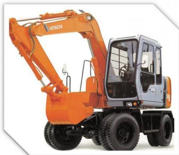
**Figure VI.3 :** Pelle hydraulique.
