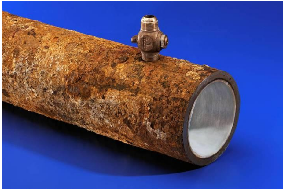
Figure VII-2: Corrosion externe dans une conduite.
