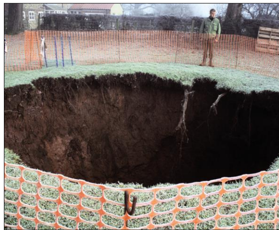
Figure 1.3- Doline formée par la dissolution de gypse Permien dans le village de Sutton Howgrave, près de Ripon. Le trou formé le 14 février 2001 avec un diamètre de 5 à 6 m et 11 m de profondeur (BGS, 2013)
